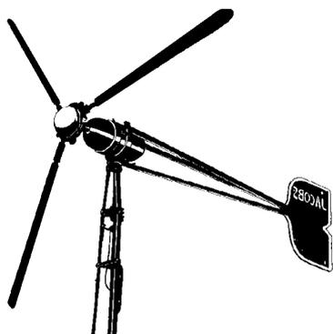
Fig V.1.- Aerogenerador Jacobs de 1 kW
